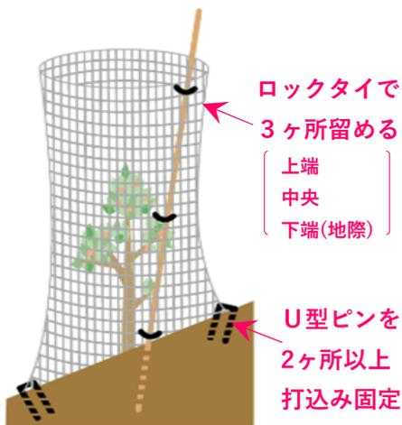
支柱は、斜面山側で、鉛直に約40cm打ち込んで固定してください。
